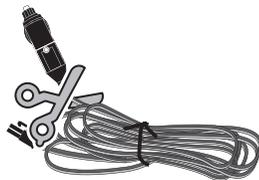
Für die Stromversorgung von der Autobatterie machen Sie den Zigarrenstecker stromlos, um innere drei Kabel herauszunehmen und loskoppeln, um Kupferkabel herauszunehmen
